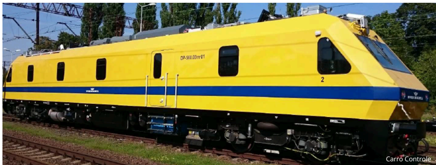
Veículos para manutenção e construção da Rede Aérea
