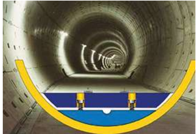
Tipo de solução: Isoamortecedor Frequência: 2Hz a 8Hz (Wagner)
