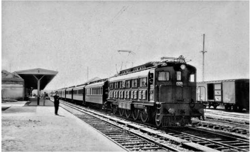
A locomotiva fornecida pela Brown Boveri Co. com seus 3.470 HP, vista em viagem de teste na estação de Itirapina em 1930 (Coleção José A. Penteadó Vignoli).
